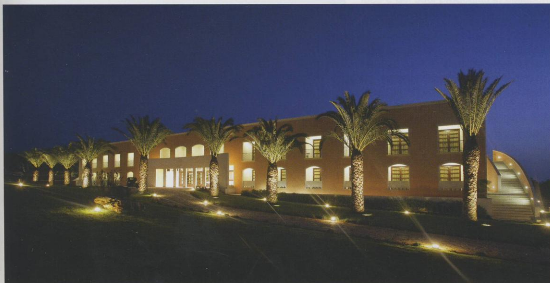
Gallipoli Resort: l'illuminazione è percepibile solo durante la sera e segna solo i percorsi pedonali e le nicchie dei balconi, con l'evidenziazione degli accessi e delle aree di incontro. L'illuminazione uplighter è concepita solo per evidenziare il verde e mantiene i livelli minimi previsti dalla normativa in materia di inquinamento luminoso (foto Bruno Barillari)
